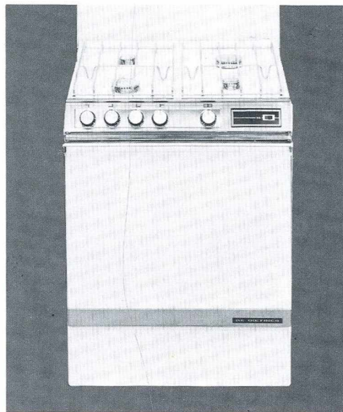
540 4 feux tous gaz - 2 brûleurs ultra-rapides AV. gauche AR. droit -puissance 3150 mth/h 2 brûleurs semi-rapides AR. gauche AV. droit puissance 1200 mth/h chapeaux de brûleurs en laiton avec dessus émaillé. Commande de tourne-broche sur le tableau de bord. Porte pleine. 2 brûleurs dans le four, 1 pour le four, puissance 4000 mth/h, 1 pour le grilloir, puissance 2500 mth/h. Puissance nominale 12700 mth/h.
