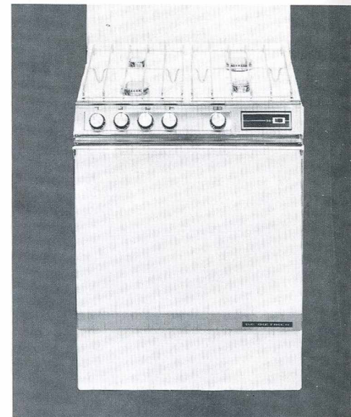
547 mêmes caractéristiques que la 545 mais avec allumage électronique sur tous les brûleurs. AR. droit brûleur thermostatique à palpeur avec sécurité thermo-couple.
